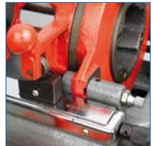
Dispositivo de bloqueo de la terraja. Die head locking device. Dispositif de blocage de la tête.
