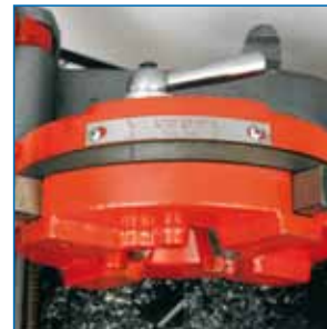
Selección de la profundidad de la rosca. Thread depth. Selection de la profondeur du filetage.
